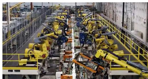
作業： 自動車ボディを各溶接工程に搬送
