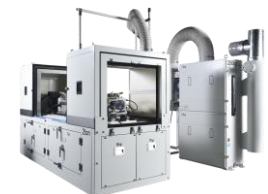
動力循環試験
